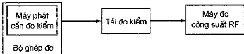
**Hình 5 - Sơ đồ đo trong điều kiện đo kiểm tối hạn**
